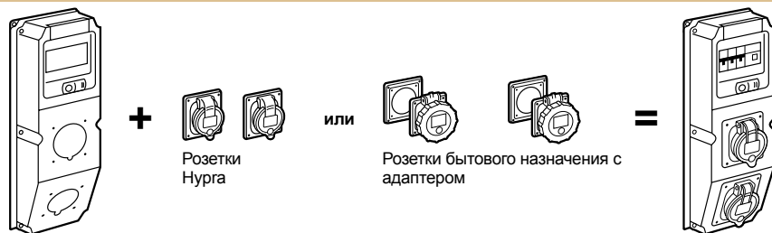
Щиток с отверстиями
